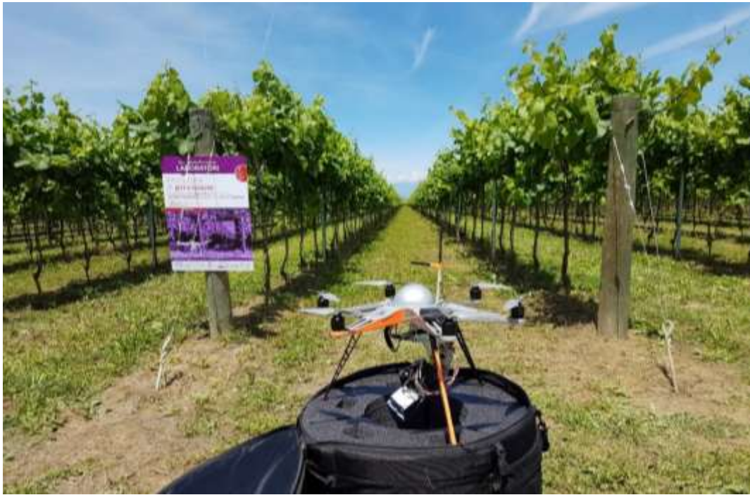
Fig.1 Multirotore "Agri-Efesto", una piattaforma UAV di nuova generazione in grado di fornire altissime prestazioni e supportare l'acquisizione simultanea di più sensori.
