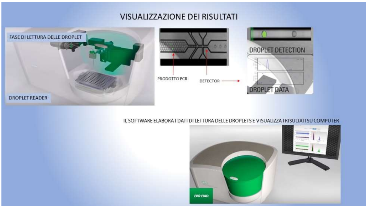
Fig. 2. Lettura della fluorescenza delle goccioline al Droplet Reader e visualizzazione dei risultati.
