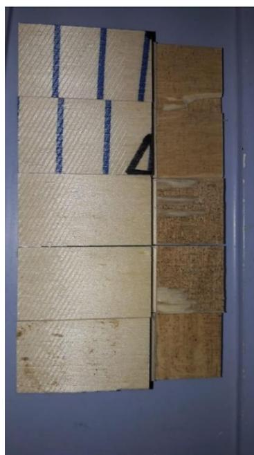
Figura 3 - Provini di compensato post prova di rottura a trazione
