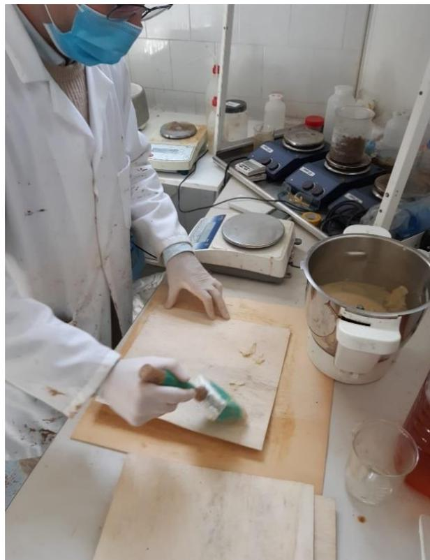
Figura 2 - Stesura della resina a base di canapa su fogli di pioppo, dosaggio 120 g/m<sup>2</sup>
