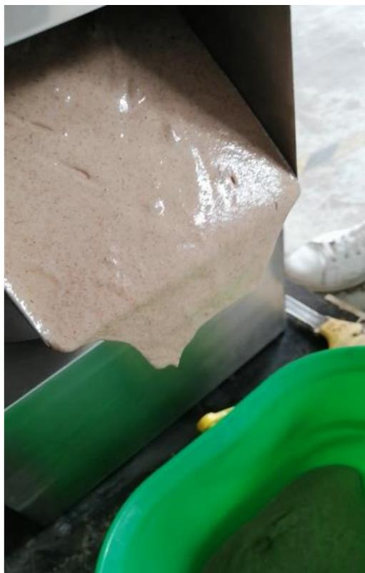
Figura 1 - Slurry ottenuto dal pannello di canapa disoleato post macinazione con mulino colloidale
