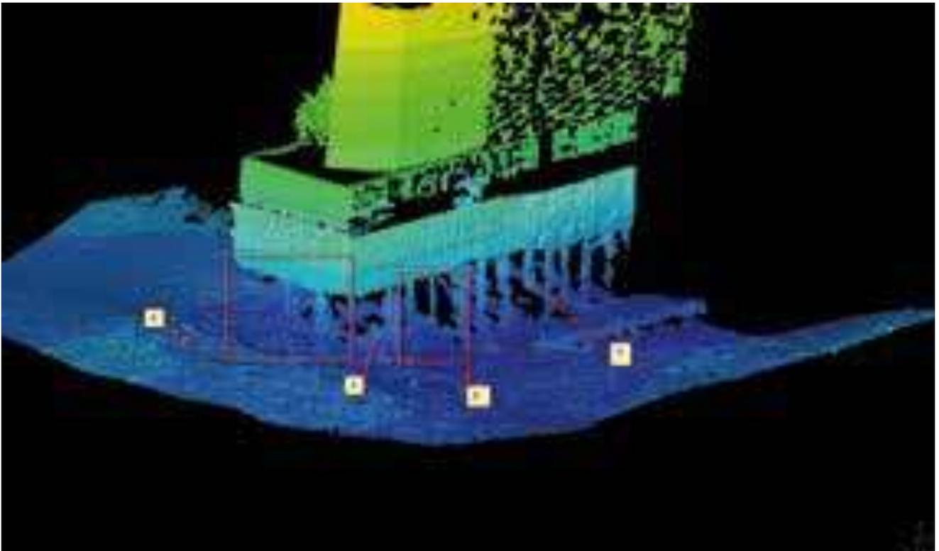
Fig. 4 - Rilievo tridimensionale della pila sinistra del ponte Vespucci.
